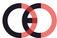
Faux marquage CE (trop proche)
